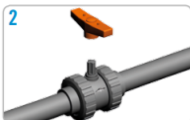
2. Para motorizar la válvula comenzamos quitando la maneta, para ello tiramos de la misma hasta extraerla.
