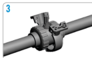
3. Colocar la abrazadera que servirá de soporte para el actuador, se coloca como se aprecia en la figura, dejando el vástago en el hueco a tal efecto.
